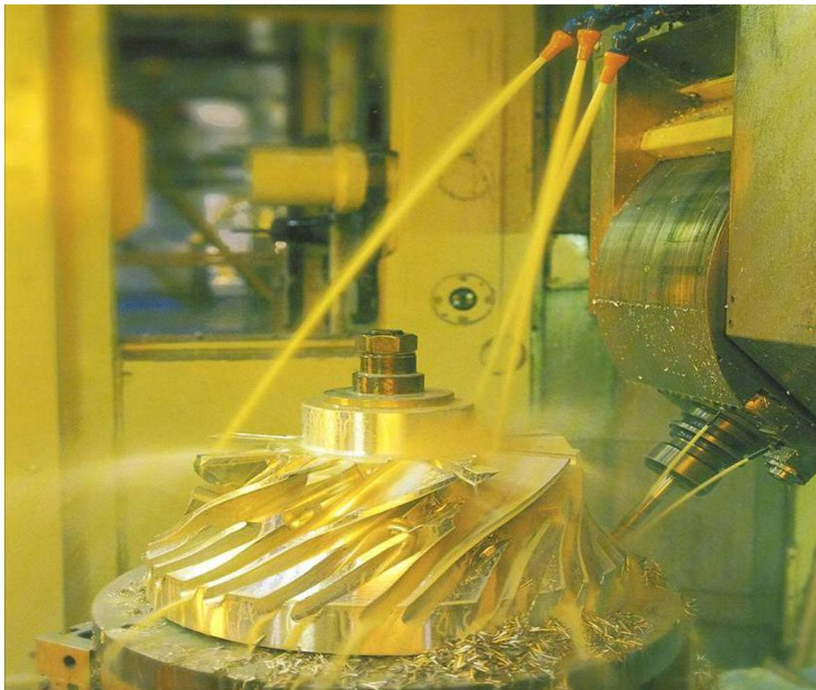
正在加工中的叶轮 Impeller in machining Рабочее колесо в процессе обработки
