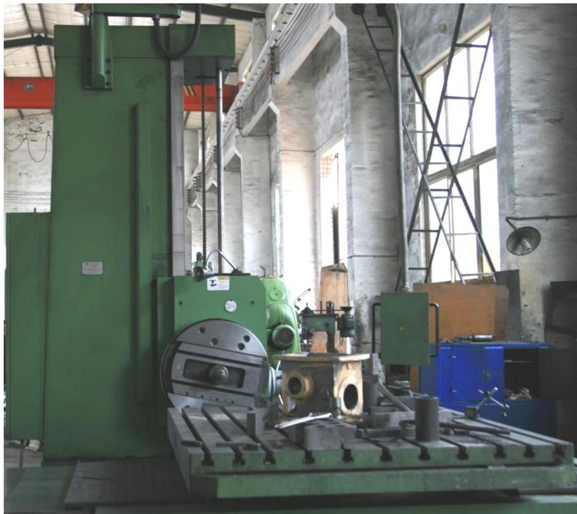
机身镗铣加工 Boring-milling of frame Расточно-фрезерная обработка корпуса
