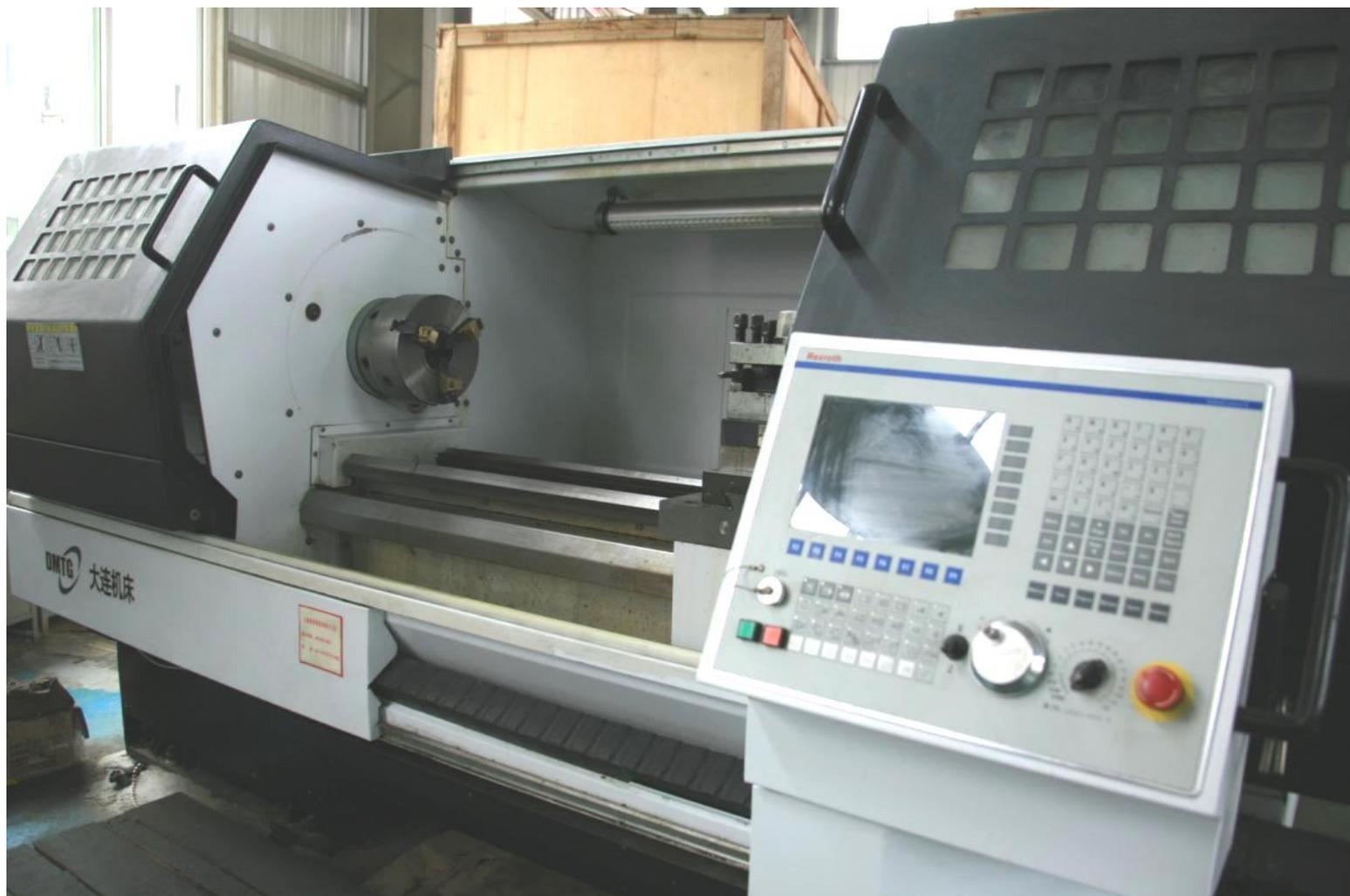
数控车床 Numerical control lathe Токарный станок с ЧПУ
